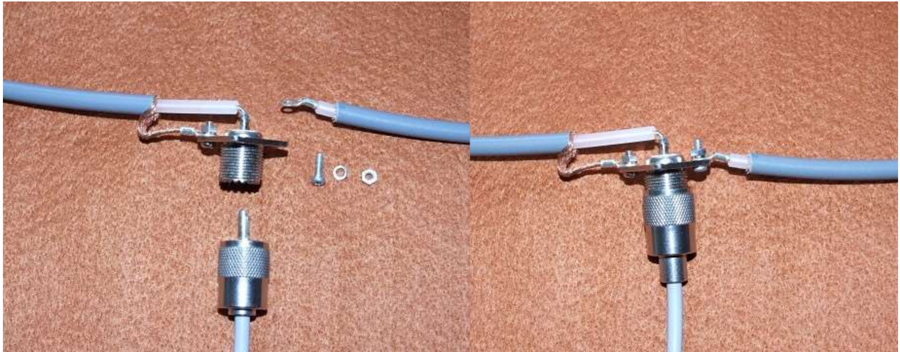
写真2. 実験用 MLA 組み立て前（左） と 組み立て後（右）
